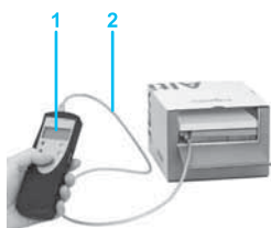
Конфигуриране на честотния регулатор, както е в опаковката чрез Multi-Loader VW3 A8 121 + кабел VW3 A8 126
