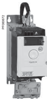
ATV 12H075M2 с EMC комплект VW3 A9 523 монтиран на EMC филтър VW3 A4 416
